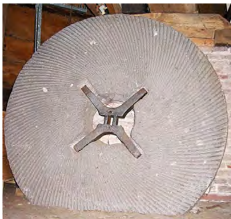
Figura 19 – Mó e respetiva anilha de encaixe, em ferro ( http://wikipedia.fr , s.v. “Meule a grains”).
